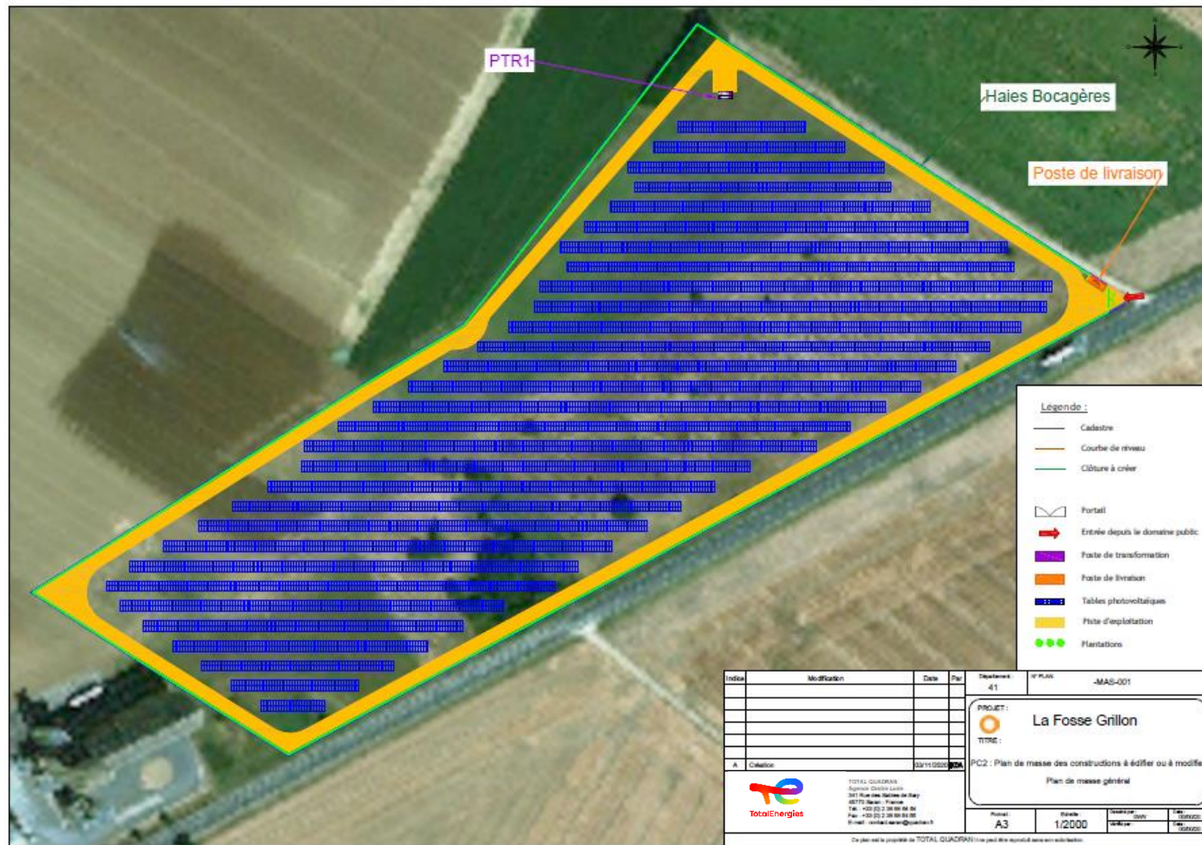
Figure 76 : Plan masse du scenario initial non retenu du projet de parc photovoltaïque de la Fosse Grillon (Source : TOTALENERGIES)
